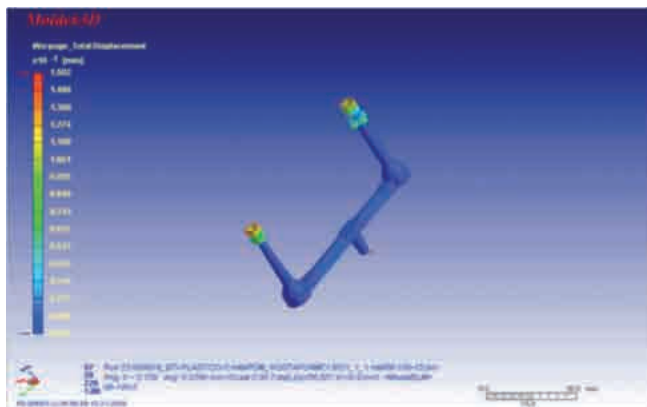
Figura 3. Ejemplo de simulación de inyección donde se muestran los resultados de las deformaciones.
