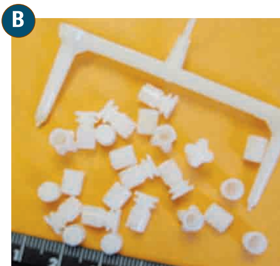
Figuras 4a y 4b. Primeras pruebas de inyección molde dos cavidades: placa cavidad, placa punzón, placa expulsión, piezas y colada.
