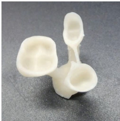
Figura 16. Piezas ya limpias de revestimiento.
