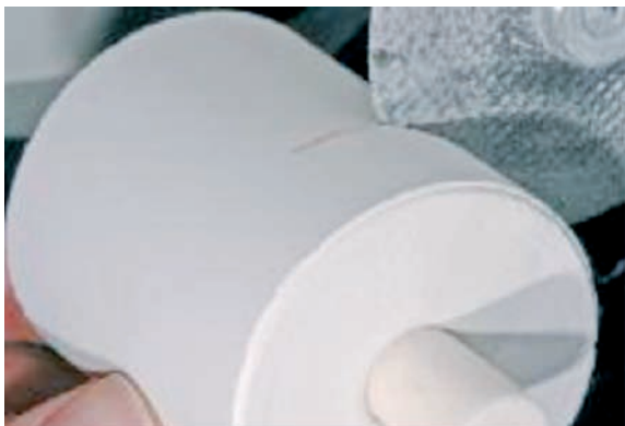
Figura 13. Eliminando la zona de revestimiento que contiene el pistón.
