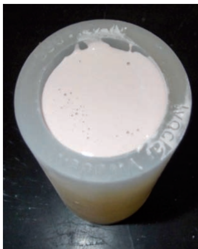
Figuras 11 y 12. Puesta en revestimiento. Se vierte el revestimiento lentamente, se llena hasta la marca y se coloca la guía del cilindro con un movimiento.
