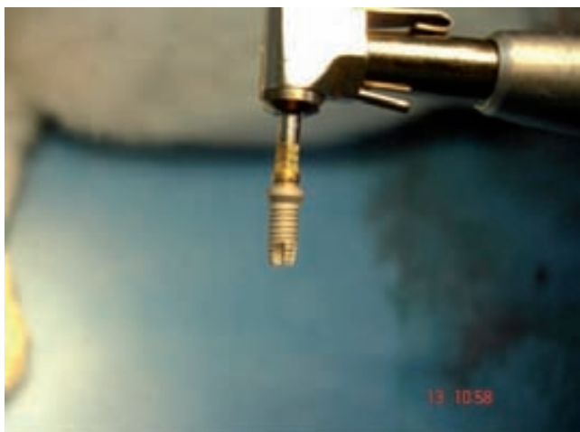
Figura 18. Imagen del taladro con el que se realizaron las perforaciones
