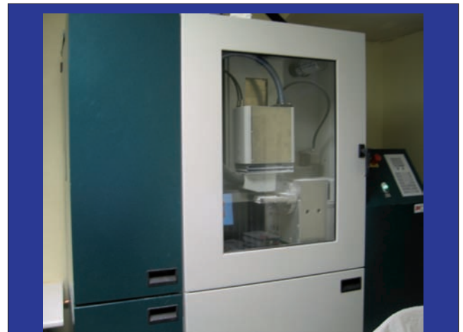
Figura 19. Unidad de fresado y horno de sinterizado del sistema LAVA
