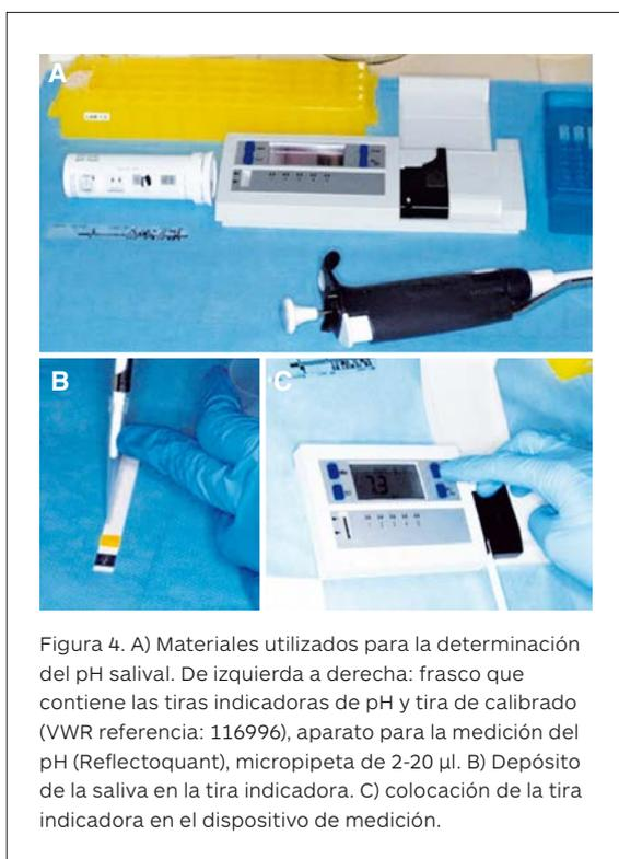
Figura 4. A) Materiales utilizados para la determinación del pH salival. De izquierda a derecha: frasco que contiene las tiras indicadoras de pH y tira de calibrado (VWR referencia: 116996), aparato para la medición del pH (Reflectoquant), micropipeta de 2-20 µl. B) Depósito de la saliva en la tira indicadora. C) colocación de la tira indicadora en el dispositivo de medición.
